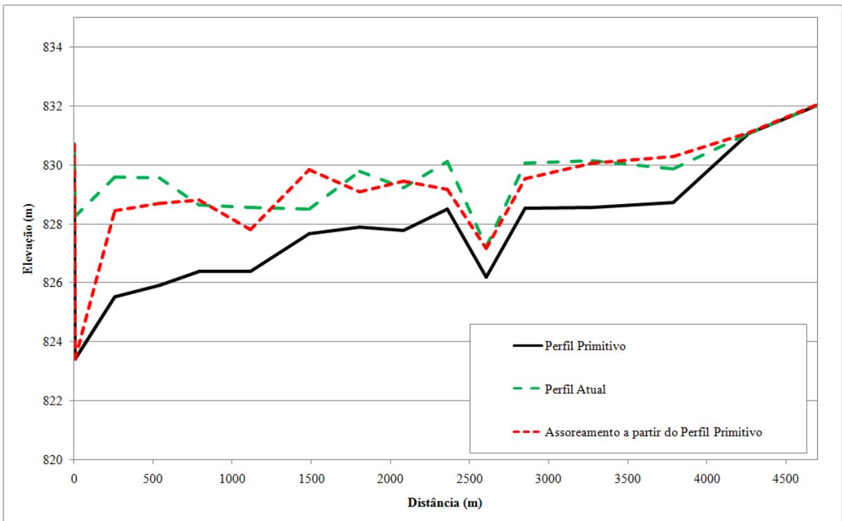
**Figura 5.10 – Resultados da simulação de assoreamento do reservatório a partir da geometria primitiva.**
