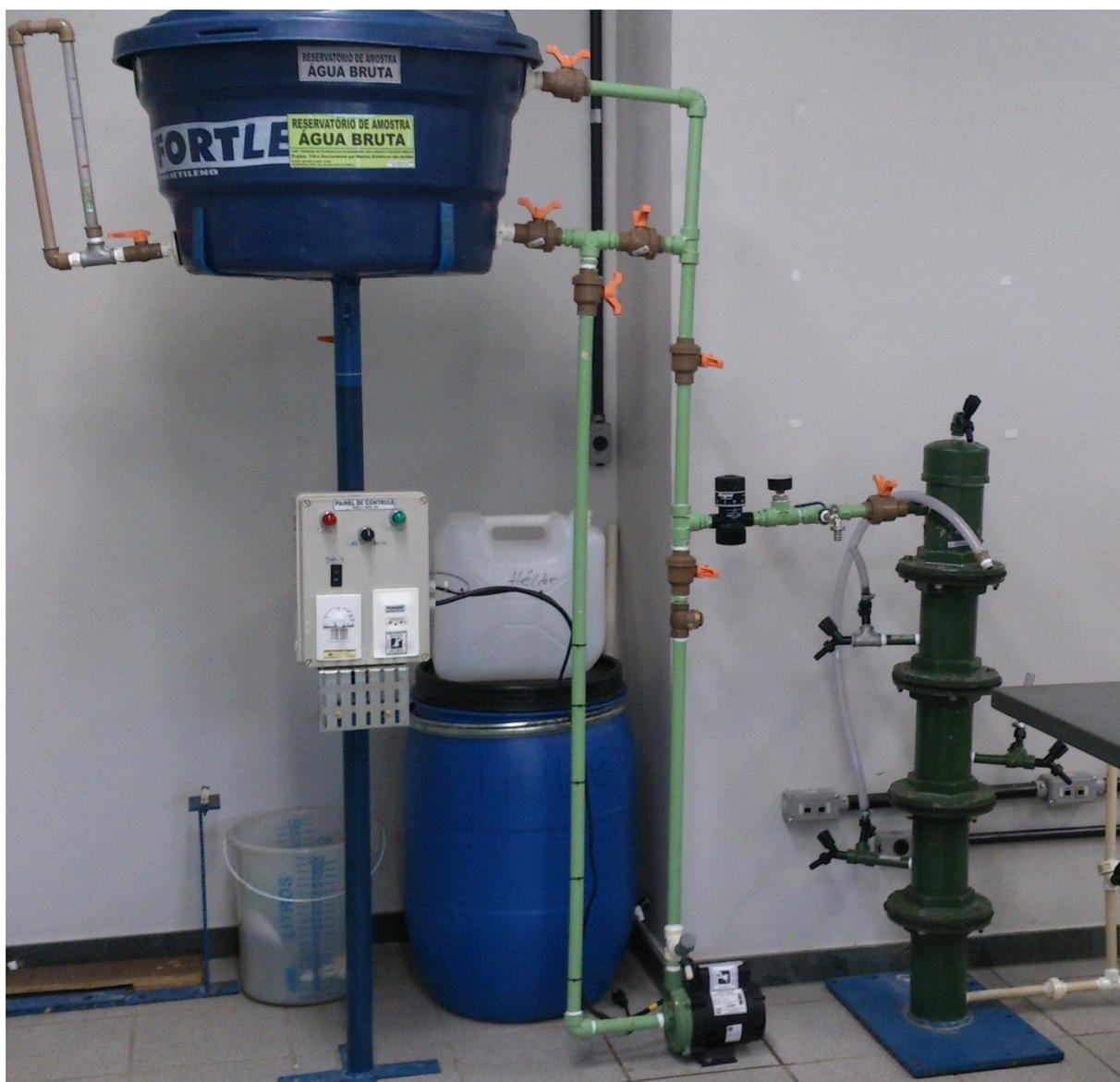
Foi utilizado um recipiente de PVC com capacidade para 100 litros, elevado a 1,2 m para fornecer água durante os ensaios de filtração. A alimentação deste recipiente e a agitação durante os ensaios sem coagulação foram feitas manualmente e a posterior utilizou-se a eletrobomba para o preparo da solução e recirculação da água nos ensaios de filtração com coagulação.
