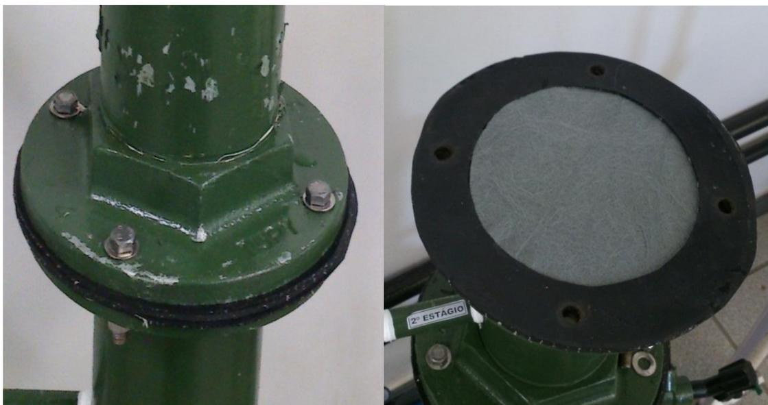
A **Figura 4.5** mostra as juntas de borracha utilizadas nos flanges como vedantes para evitar o vazamento. Nesta figura são ilustrados os detalhes de sua colocação em torno da manta, na qual as partes inferior e superior são colocadas às juntas que apresentam um diâmetro interno de 100 mm igual ao da superfície de filtração do sistema. E a junta intermédia com 175 mm de diâmetro interno fazia a cobertura lateral da manta.
