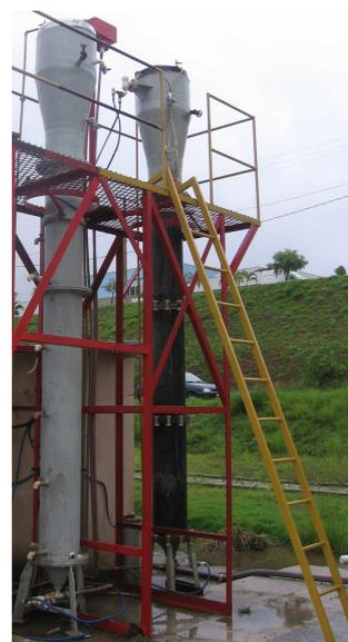
**Figura 5.3**- Vista dos reatores UASB, escala piloto (R<sub>conv</sub> e R<sub>mod</sub>)
