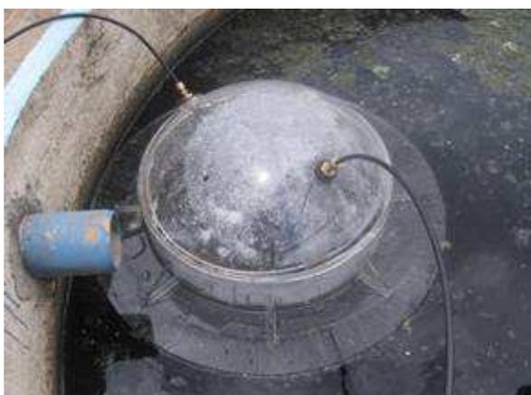
**Figura 6.4** - Câmara de fluxo colocada na superfície do decantador do reator UASB.
