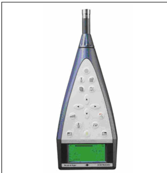
**FIGURA 4-22** – Medidor de nível sonoro B&K 2238.
