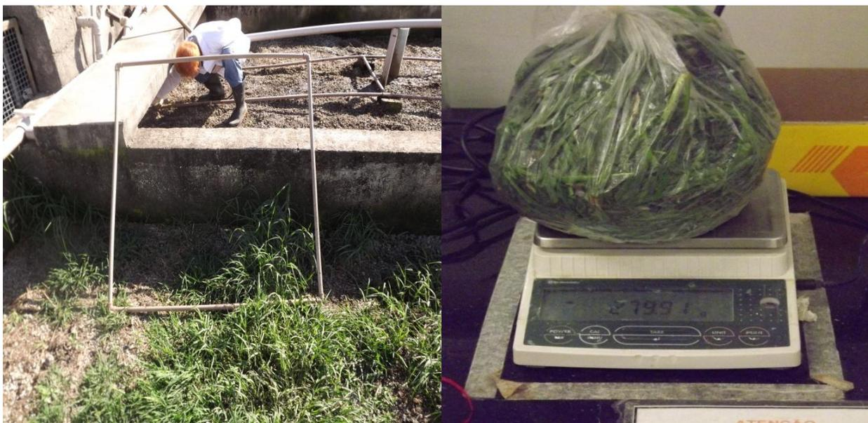
**Figura 4.7:** Quadrado utilizado para coleta do material vegetal (esquerda) e pesagem do material coletado (direita)
