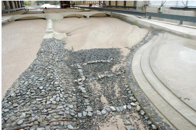
**Figura 4-24:** Modelo físico para simulação da dinâmica fluvial do Rio Isar
